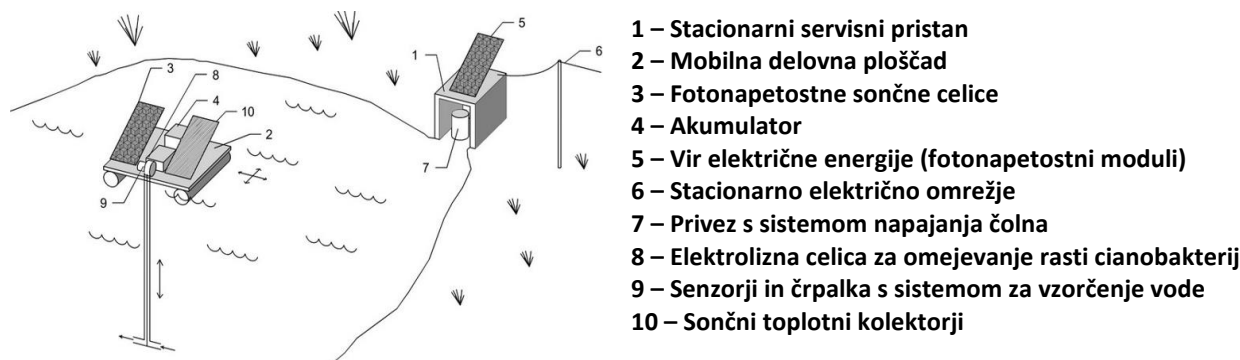
Slika 1: Stacionarni pristan in mobilna delovna ploščad za zaznavanje in uravnavanje rasti cianobakterij.
