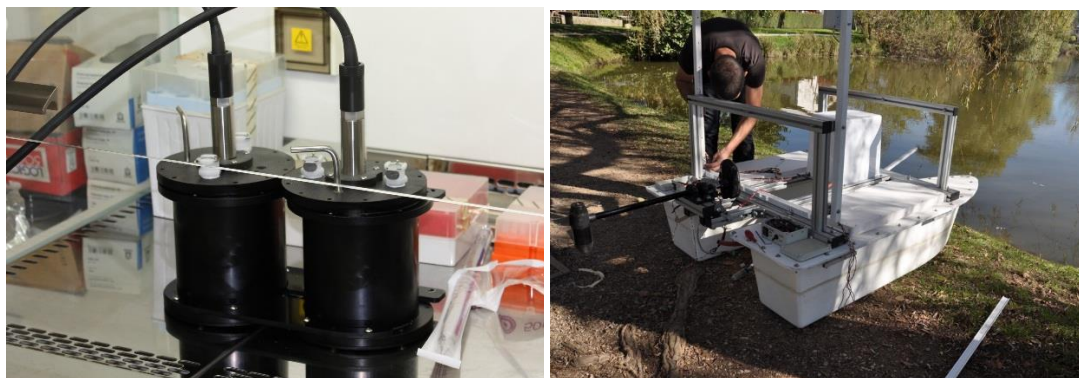
Slika 2: Levo: Sondi s senzorji za zaznavanje klorofila in fikocianina. Desno: montaža plovila.
