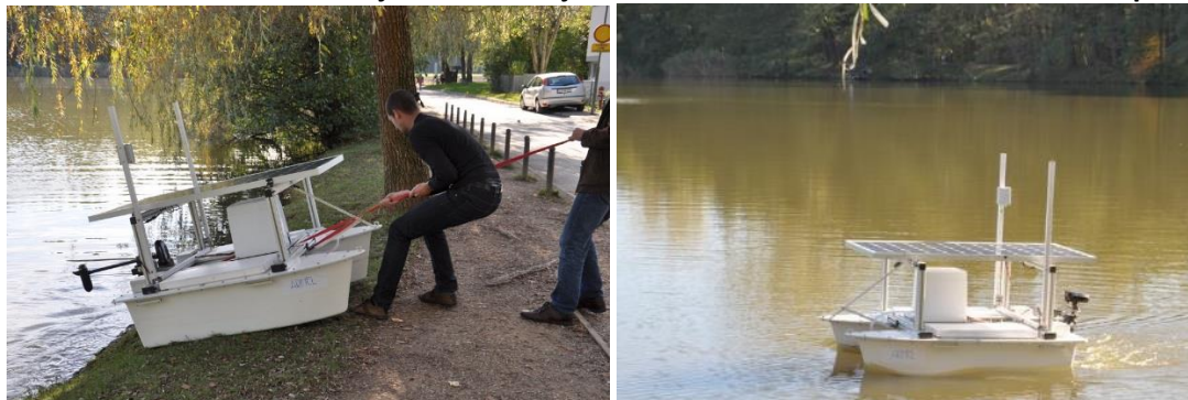
Slika 3: Spuščanje in testna plovba prototipa plovila – mobilne merilne delovne ploščadi.
